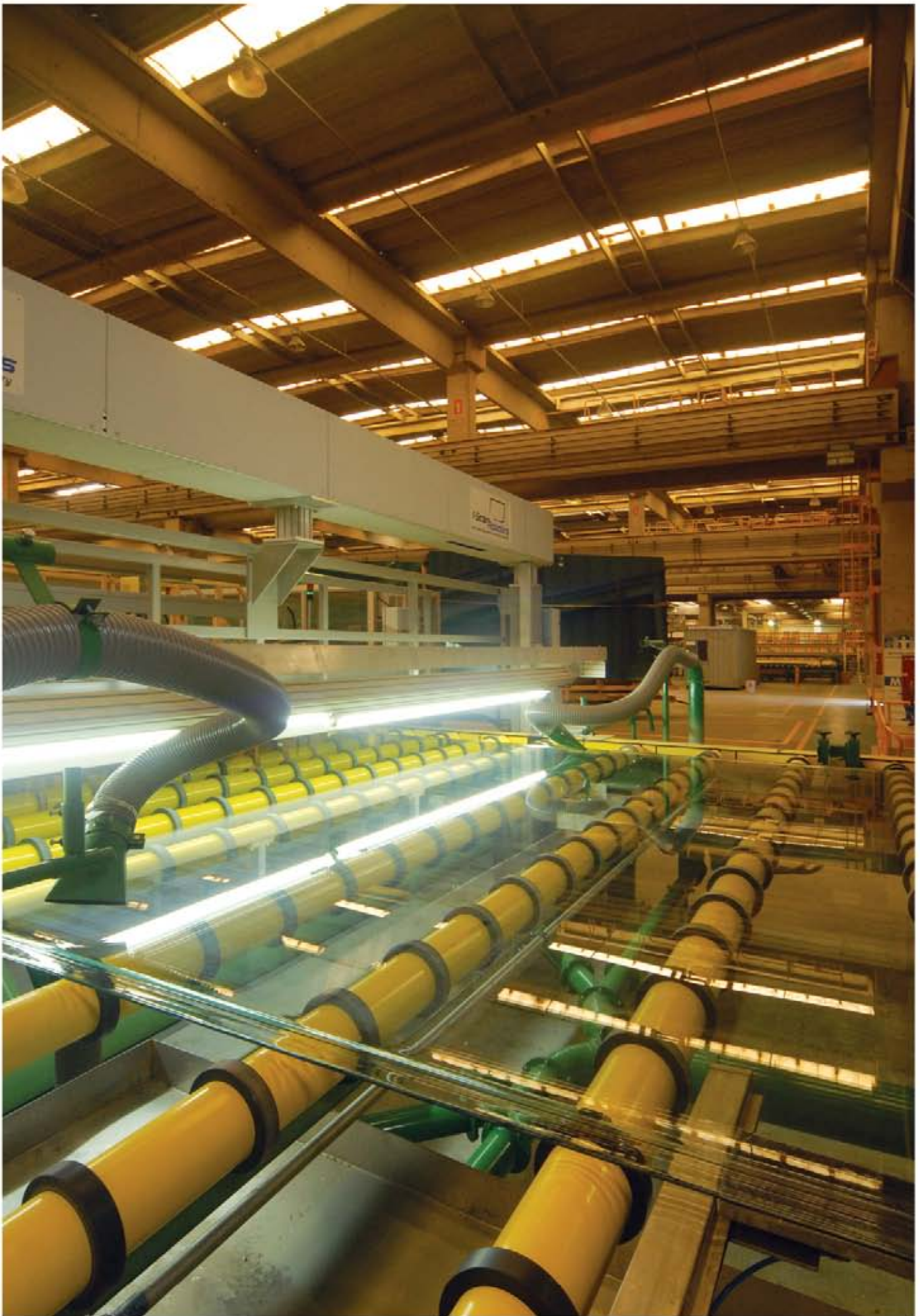
Toda a linha de produção do vidro Float® é automatizada.
