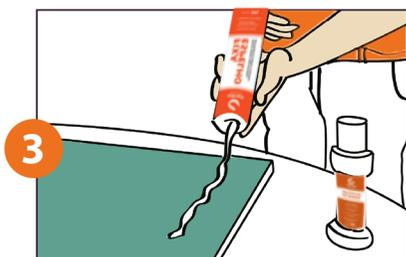
No lado pintado do vidro, aplique cordões retos e verticais de silicone à base de cura neutra, conforme recomenda a ABNT/NBR 15198, ou Fixa Espelho da Cebrace.
