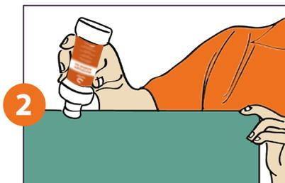
A Cebrace recomenda a aplicação do protetor de borda em todo o perímetro do espelho com a inclinação de 45° em relação ao costado. São recomendadas 2 camadas: aguarde 15 minutos após a primeira aplicação e repita a operação.
