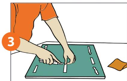
3 É preciso manter um distanciamento de 3mm entre o espelho e a parede, permitindo o escoamento da umidade. Isso pode ser feito com calços de apoio e espaçadores ou com fita dupla face 3mm, isenta de solventes orgânicos, conforme NBR 15198 (3M - Scotch-Mount 4008).
