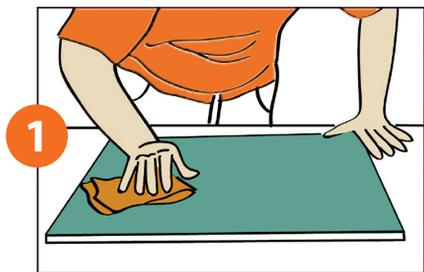
1 Verifique se a superfície onde será feita a colagem está limpa e nivelada. Limpe o lado pintado do espelho com um pano macio umedecido em álcool. Passe um pano seco para retirar o excesso.
