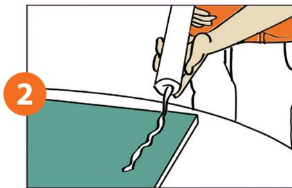
2 No lado pintado do vidro, aplique cordões retos e verticais de silicone à base de cura neutra, conforme recomenda a ABNT/NBR 15198.
