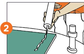
No lado pintado do vidro, aplique cordões retos e verticais de silicone à base de cura neutra, conforme recomenda a ABNT/NBR 15198.
